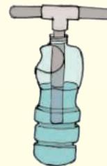
Comprobar el buen funcionamiento de la válvula de seguridad (burbujeará si está muy inflado el reactor y el reservorio)
